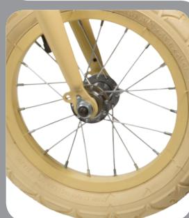
*Utilice la llave inglesa proporcionada, apriete los tornillos exteriores.*
