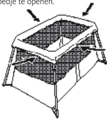
2. De voetpluggen eruit draaien en het bedmateriaal losmaken van de poten.
